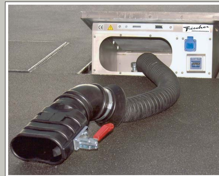
Unterflurabsauganlage mit versenkbarem Abgasschlauch, drehbarem Bogentrichter 60° und Aufstecktrichter mit Feststellklemmzange für Doppelrohrpuffanlagen einschließlich Energieversorgung. Pneumatisch betätigt. Die Anlage wird als fertige Einbaueinheit mit Hochtemperaturrohrleitung für die Sticheleitungen geliefert und an einem Zentralventilator Typ FD angeschlossen.
