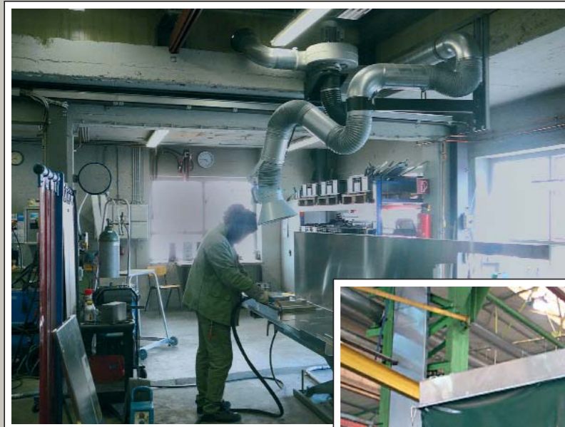
Aluminium Schweißplatz mit sehr flexiblem und leichtgängigen Absaugarm NW 200 - 3 m lang.
