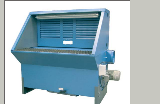
Schleiftisch mit Unter- und Hinterwandabsaugung mit integriertem Ventilator und Patronenfilter für den Umluftbetrieb.
