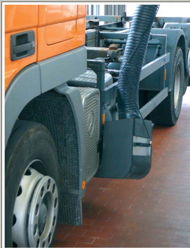
„SLS-Truck“ zum automatischen Mitführen des Erfassungselementes und Absaugung beim Mitfahren am Bremsenprüfstand in einer Mercedes-Benz LKW Werkstatt.
