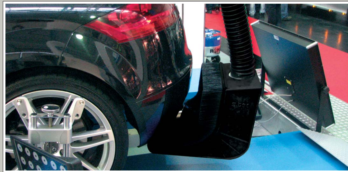
Neues Erfassungselement vom Typ „SLS-Car“ auf einem Vermessungsarbeitsplatz in einer AUDI-Werkstatt.
