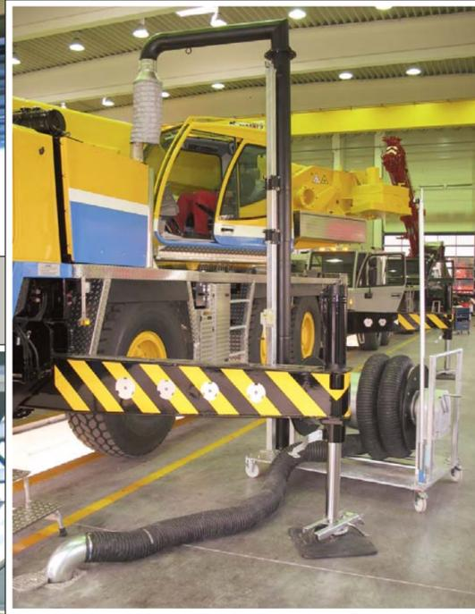
Absaugwagen mit Schlauchaufroller für hoch liegende Auspuffanlagen zum Betrieb an einer Unterflurabsauganlage
