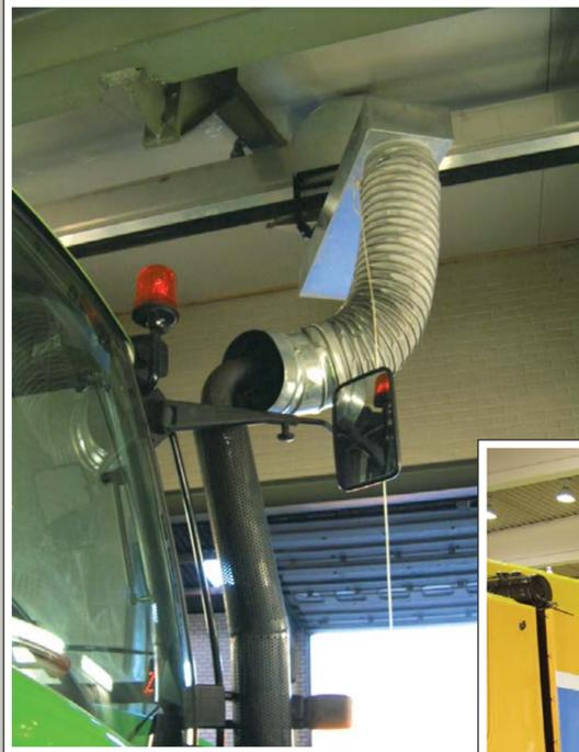
Hochtemperatur - Absaugeinheit für Leistungsprüfstand
