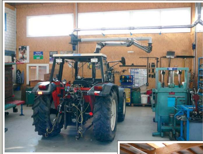
Absaugarm mit 8 m Reichweite für nach oben gerichtete Auspuffendrohre
