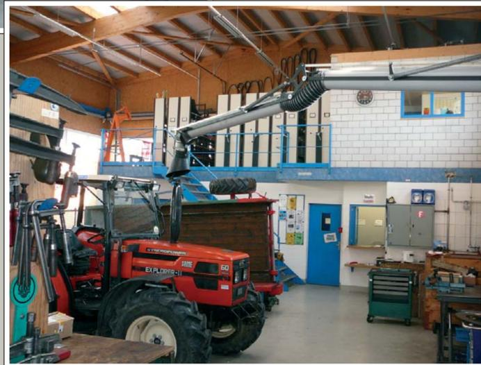
Absauganlage mit großer Reichweite in der Landmaschinenwerkstatt
