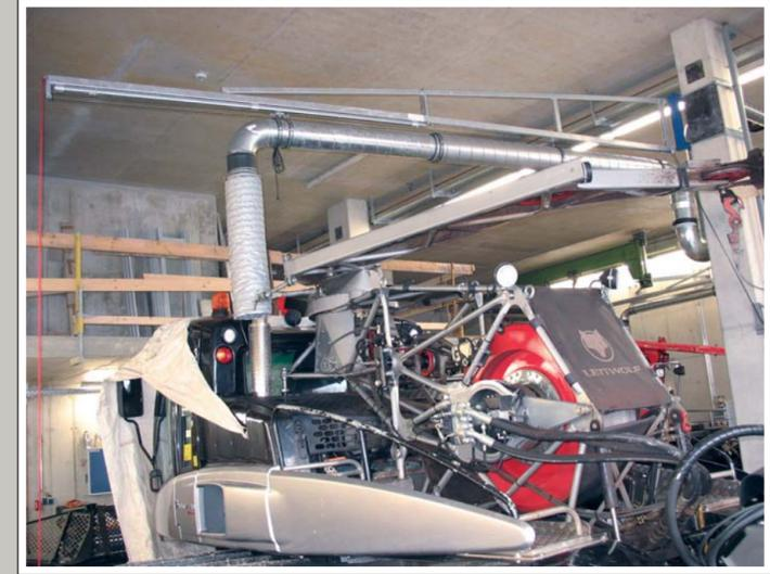
Teleskop-Rohrausleger in Hochtemperaturausführung für Sonderfahrzeuge
