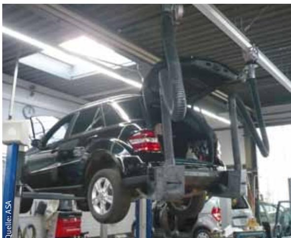
Bild links: Saugschlitzkanal mit 2 Saug-einheiten für 2-flutige Aus-puffanlagen
